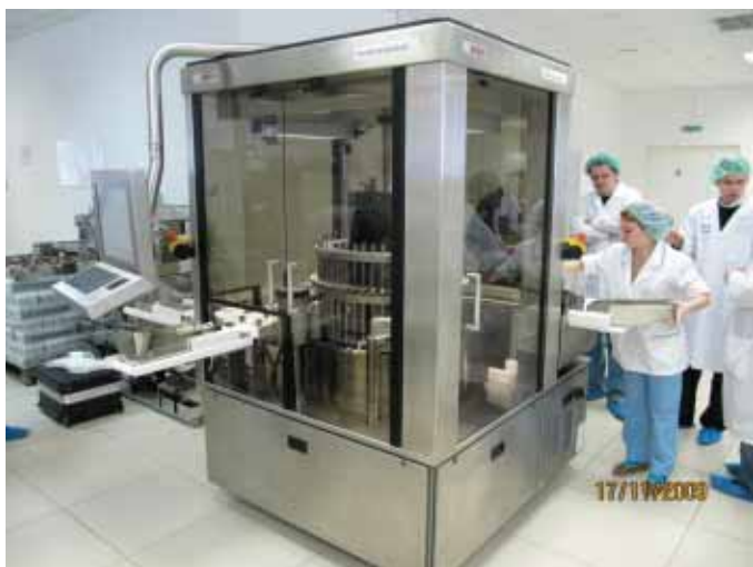
Приёмка и заводские испытания инспекционной машины Bosch Moeller&Devicon Slitec® на заводе ОАО «Фармстандарт-Уфавита»
